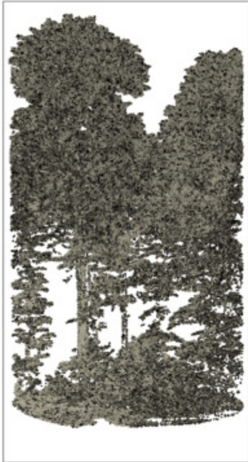
ALS Point Cloud
